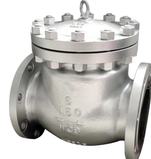
stalen terugslagklep met flapper / zonder veer ANSI huis : ASTM A216 WCB temp. : -20°C +400°C volgens ASTM A182 / trim F6 fig 759 : ansi 150 lbs / 2" - 12" fig 759 : ansi 300 lbs / 2" - 12"
