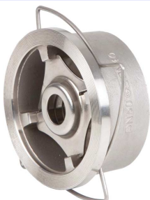
inox terugslagklep tussenbouwtype tussenbouw ts. flenzen PN10/16/40 - 150 lbs fig 784 : DN15 - DN200 max. druk : 40 bar tot dn100 / 25 bar > DN100 temp. : -20°C +240°C huis / klep / veer : inox 316 inbouw lengte volgens DIN 3202 K4 metaaldichtend
