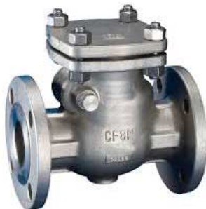
inox terugslagklep PN16 inox zitting / metaaldichtend huis : inox 1.4408 / 316 temp. : -30°C +200°C fig 764 : PN16 / DN40 - DN300 inbouw lengte volgens DIN 3202 F6 flenzen volgens PN16 RF
