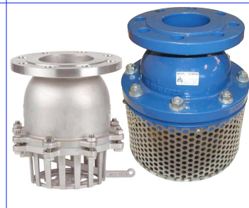
voetkleppen met filterzeef PN16 fig 795 : gietijzeren huis / stalen zeef temp. : -10°C +90°C PN16 : DN50 - DN300 fig 797 : inox 316 huis en zeef temp. : -25°C +150°C PN16 : DN50 - DN200 manueel leegloop-hendel viton zitting / telfon dichtingen
