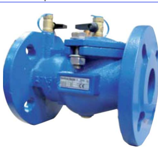
BELGAQUA gekeurde terugslagklep PN10 EA terugstroombeveiliging DN40 - DN250 huis gietijzer met epoxy coating 2 boringen met controlekraan 1/2" behalve DN40/50 : 1/4" 1 boring met leegloopstop 1/2" behalve DN40/50 : 1/4" temp. : max +100°C
