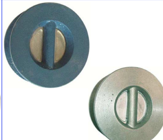
terugslagklep tussenbouwtype dubbelplaat tussenb. ts. flenzen PN10/16 ( fig 786 : PN25) max. druk : 16 bar tot DN300 / 10 bar >DN300 DN50 - DN600 fig 786T : inox 316 huis en klep/viton dichting temp. : -10°C +200°C fig 785 : gietijzer huis/RVS klep / EPDM dicht. temp. : -10°C +110°C fig 785T : gietijzer huis en klep /NBR dichting temp. : -10°C +80°C
