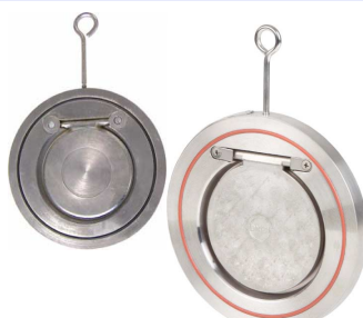
terugslagklep tussenbouwtype enkelplaat tussenbouw tussen flenzen PN10/16 - 150 lbs max. druk : 16 bar tot DN200 / 10 bar >DN200 DN40 - DN600 fig 783 : inox 316 huis en klep / viton dichting temp. : -10°C +180°C fig 782 : stalen huis en klep / EPDM dichting temp. : -10°C +110°C fig 782NBR : stalen huis en klep / NBR dich. temp. : -10°C +80°C
