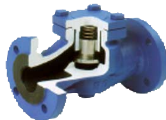
inox klep - veer en zitting fig 760 : gietijzer PN16 : DN 15 - DN200 temp. : -10°C +300°C fig 761 : staal PN40 : DN 15 - DN200 fig 762 : staal PN63 : DN 15 - DN200 fig 763 : staal PN100 : DN 15 - DN200 temp. : -20°C +400°C fig 765 : inox 316 PN40 : DN 15 - DN200 temp. : -30°C +400°C
