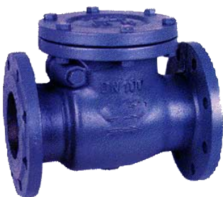
gietijzeren terugslagklep PN16 met flapper / zonder veer fig 750 : DN40 - DN200 EPDM rubber beklede klep temp. : -10°C +90°C inbouw lengte volgens DIN 3202 F6 flenzen volgens PN16 RF fig 751 : DN40 - DN500 metaaldichtend PN10/16
